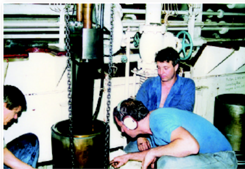
Nahoře: motorář 1. třídy Zdeněk Kunc při revizi pístu hlavního motoru.
